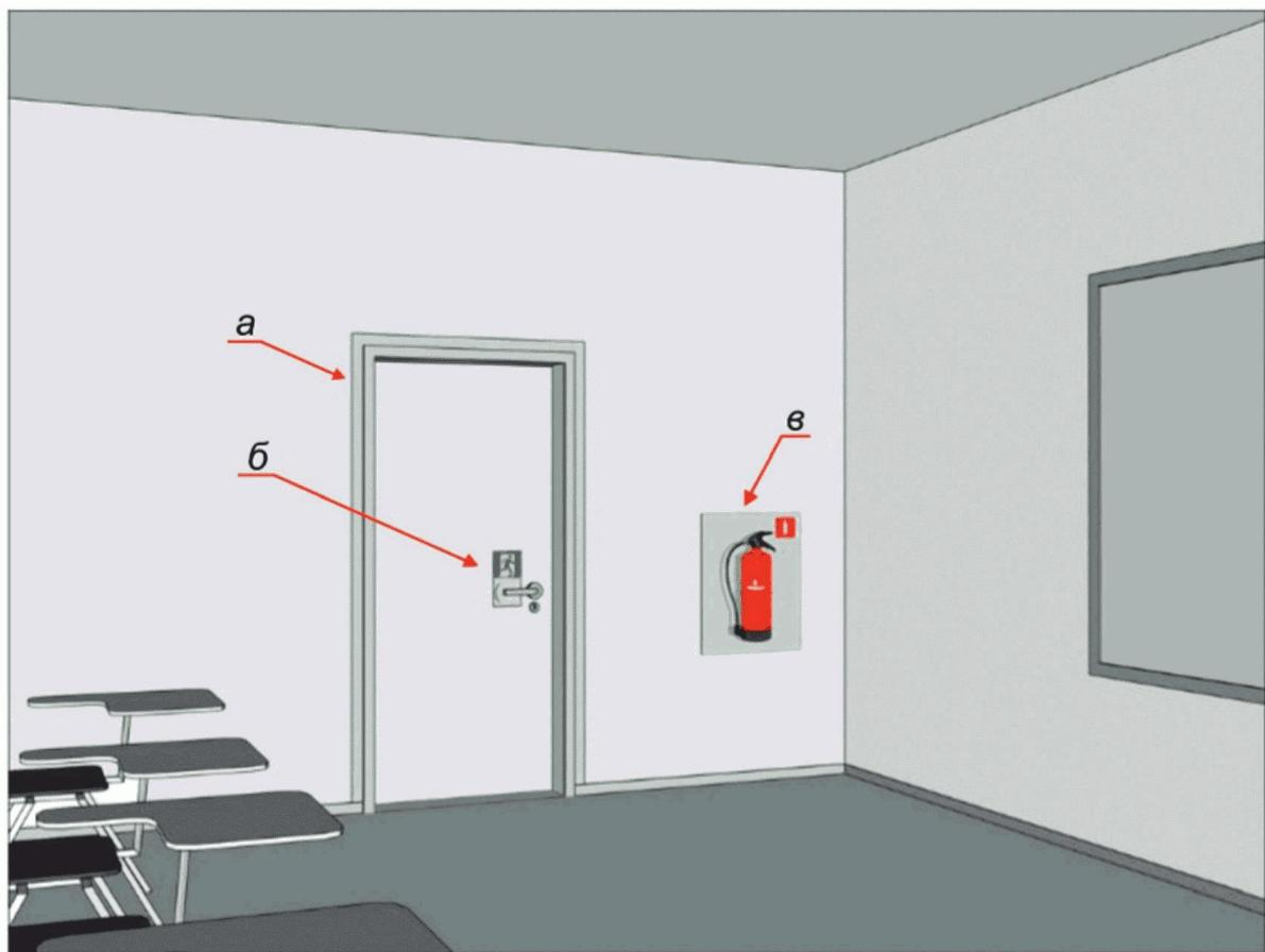
а - обозначение контура двери фотолюминесцентной полосой; б - обозначение механизма
