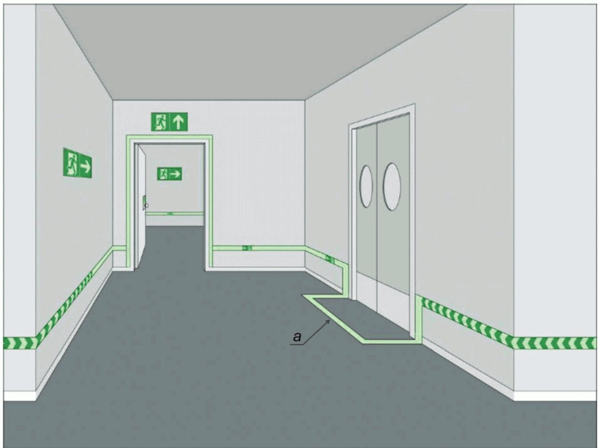
а - обозначение геометрии безопасного эвакуационного пути напольной фотолюминесцентной полосой
