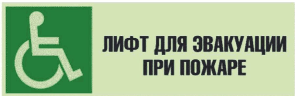
Рисунок 8 - Пример комбинированного знака обозначения лифта для эвакуации инвалидов-
